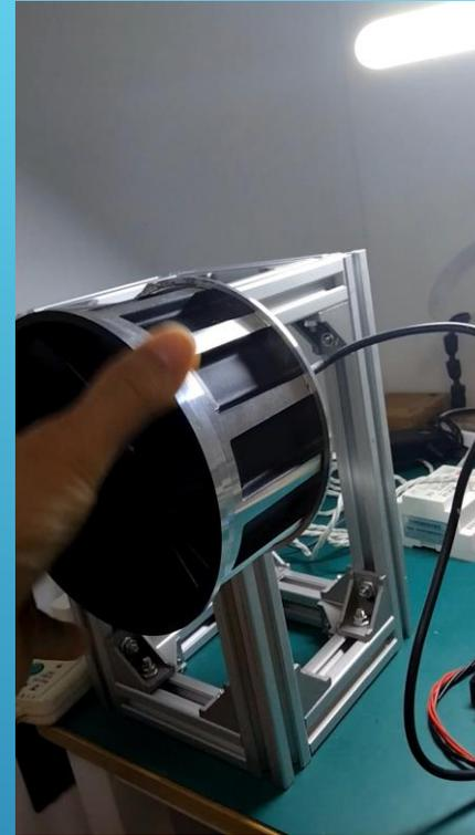
外力追従原理に従って、プログラムを開発、複数のモータで機能をテストしました。負荷装置として使用出来ます、継続して使い良さの向上は必要です。
